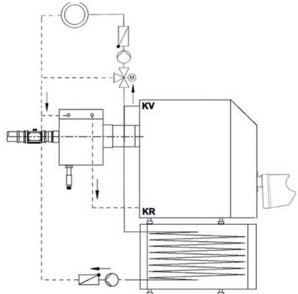
**Der Einsatz eines 4-Wege-Mischers ist aufgrund der Rücklaufftemperaturanhebung für Brennwertnutzung nicht sinnvoll.**
