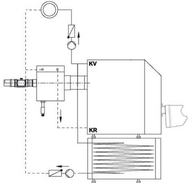
Beispiel 3: Heizkessel mit einem Verteiler und mehreren separaten Heizkreisen, die alle auf einen gemeinsamen Rücklauf geführt werden.
