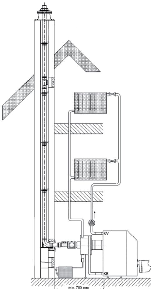
Es dürfen nur Bauart zugelassene PP Schornsteinsysteme verwendet werden.
