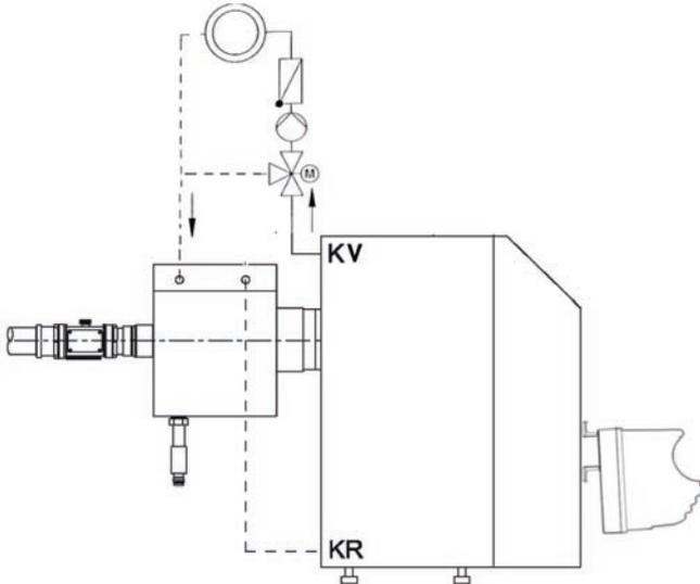
Beispiel 5: Kessel mit 3-Wege-Mischer und Warmwasserbereitung über Speicherladepumpe:
